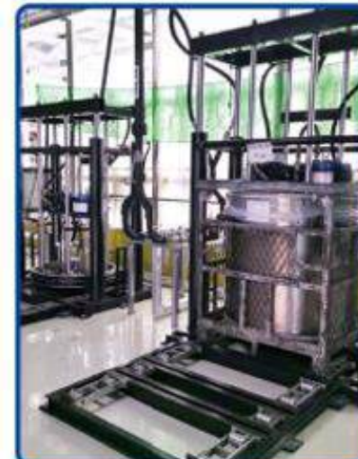
1000L四缸气动打胶升降机客户现场组装测试
