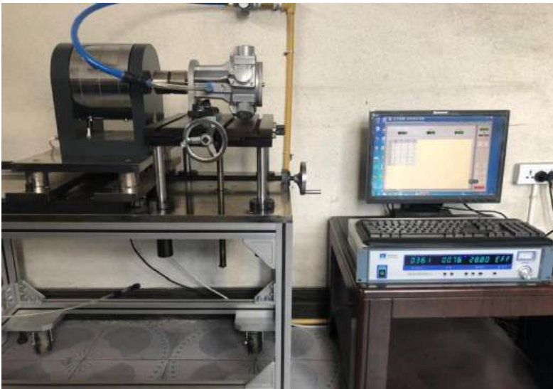
活塞式气动马达功率扭力技术参数检测
