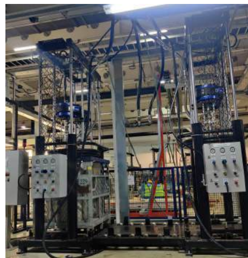
1000L四缸气动打胶泵升降机客户现场组装测试
