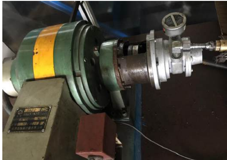
叶片式气动马达功率转速检测
