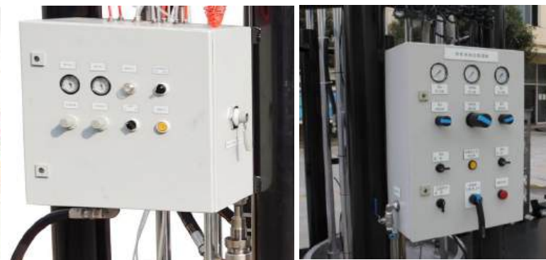
气控箱（气动元件SMC） 气控箱（气动元件Festo）
