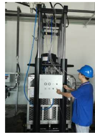
1000L四缸气动打胶泵升降机客户现场组装测试
