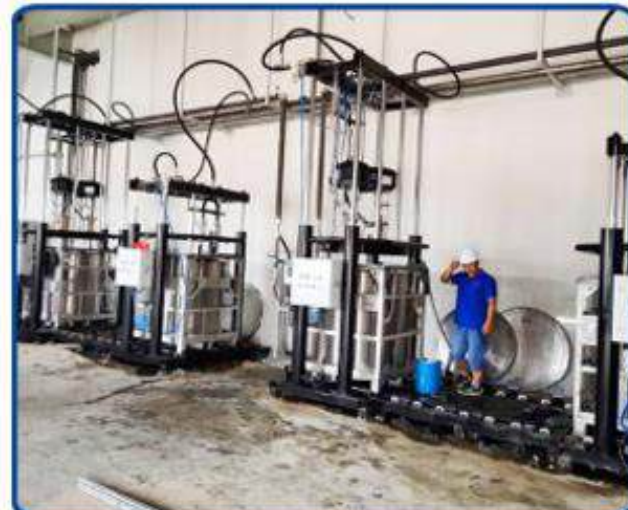
1000L四缸气动打胶升降机客户现场组装测试
